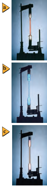
الشكل 4-9 عند تطبيق فرق جهد عال على عينة غاز بيتت الغاز ضوءاً ذا توهج خاص به، فيتوهج غاز الهيدروجين بضوء أحمر مزرق (A)، ويتوهج غاز الزئبق بضوء أزرق برتقالي - وردي اللون (C).
