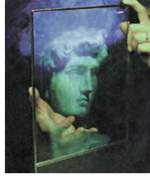
الشكل 20-9 يتشكل الهولوجرام عندما يسجل تداخل شعاعي الليزر كلاً من كثافة وطور الضوء المنبعث من الجسم على الفيلم.
