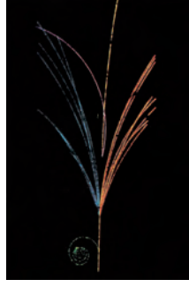
الشكل 11-13 تُظهر صورة حجرة فضاة اللون الوهمية لمسار الجسيمات المشحونة.
