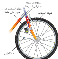
يستخدم المجس الذي يعمل وفق تأثير هول في مقياس سرعة الدراجة الهوائية لقياس سرعتها.
