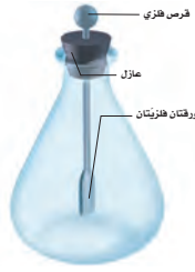
■ الشكل 1-6 الكشاف الكهربائي؛ جهاز يستخدم للكشف عن الشحنات الكهربائية. في الكشاف الكهربائي المتعادل تكون الورقتان معلقتين رأسياً بحرية، وتلامس إحداهما الأخرى.
