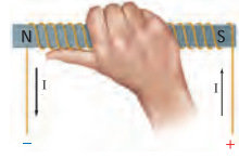
الشكل 12-5 تستخدم القاعدة الثانية لليد اليمنى في تحديد قطبية المغناطيس الكهربائي.
