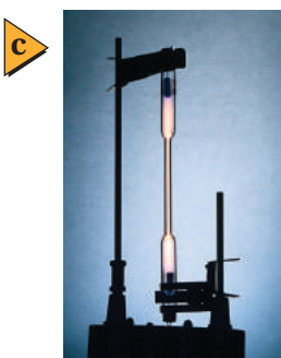
■ الشكل 4-5 عند تطبيق فرق جهد عال على عينة غاز يبعث الغاز ضوءاً ذا توهج خاص به؛ فيتوهج غاز الهيدروجين بضوء أحمر مزرق (a)، ويتوهج غاز الزئبق بضوء أزرق (b)، ويتوهج غاز النيتروجين بضوء برتقالي - وردي اللون (c).
